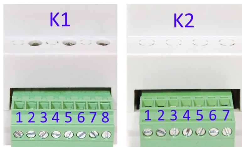
Рис. 3.1. Расположение контактов в разъемах.
