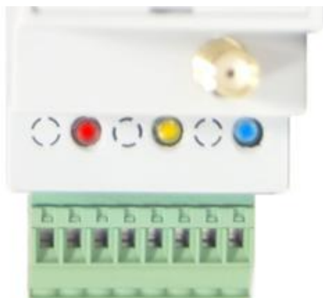
Рис. 3.2. Расположение индикаторов на терминале.
